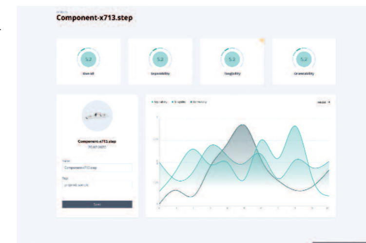
NeuroCAD wertet verschiedene Eigenschaften eines Bauteils hinsichtlich seiner Automatisierbarkeit aus, bspw. die Vereinzelnbarkeit oder die Greifbarkeit.
